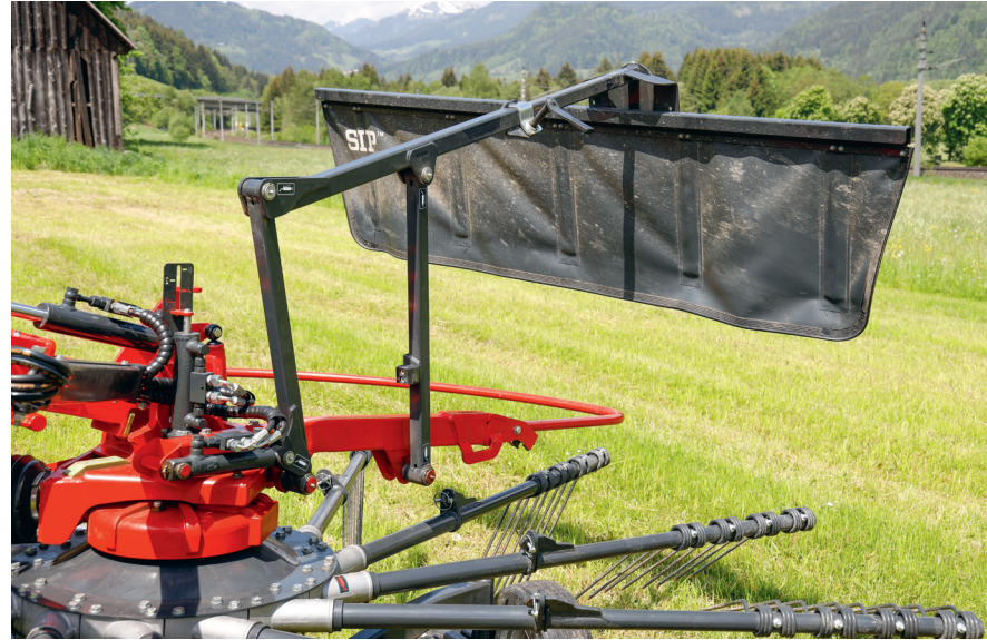
Das hintere Schwadtuch lässt sich hydraulisch klappen und ist teleskopierbar.
