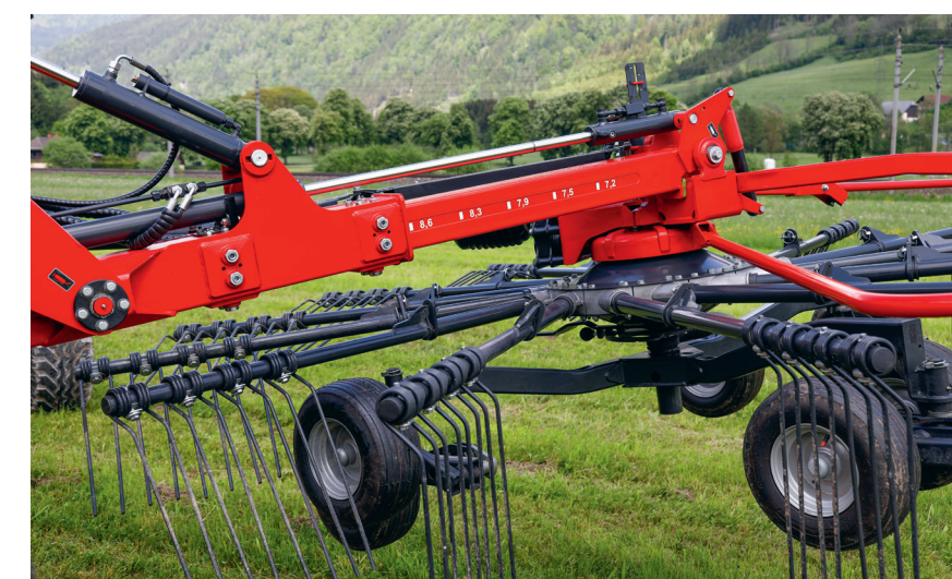
Mit den teleskopierbaren Kreiselarmen lässt sich die Arbeitsbreite zwischen 7,20 und 8,60 m verstellen: 8,60 m für zwei Einzelschwade und 7,20 für einen Doppelschwad.
