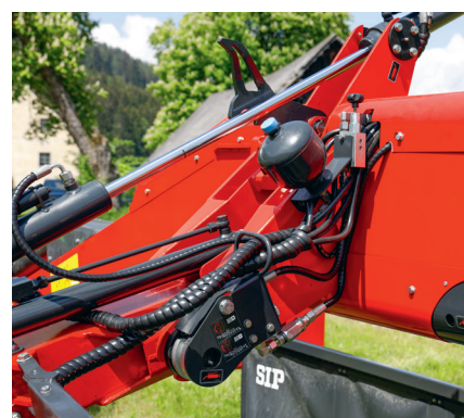
Hydropneumatische Entlastung der Kreisel.
