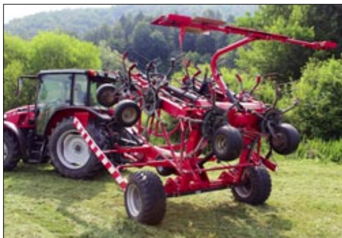
Preklapljanje v transportni položaj je zagotovljeno s sekvenčnim krmiljenjem z dvosmernim cilindrom.
