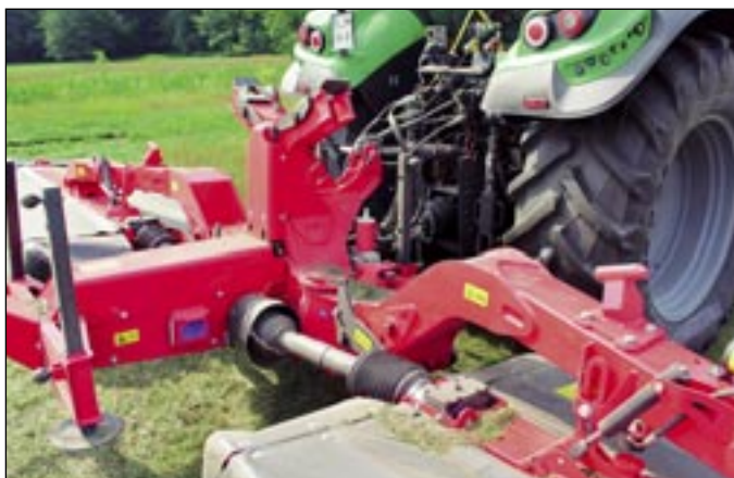
Neposredni pogon preko kardanske gredi, kotnega gonila in dvojnega kardanskega zgloba na prvi disk.
