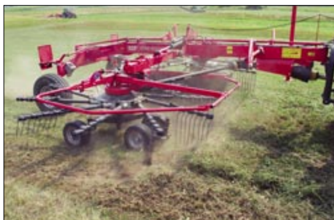
Širina zgrabka se nastavi glede na količino krme in širino pobiralne enote za zgrabljajnikom. Bolj skupaj je rotor, ožji je zgrabek.
