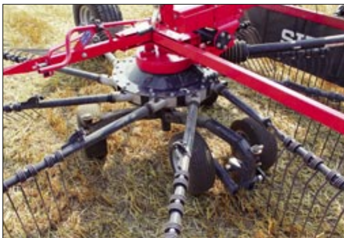
Koračno tandem podvozje za boljše in hitrejšo sledenje zgrabljavnika.
