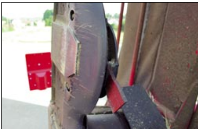
Kosilnica ima serijsko hitro menjavo nožev (QCS) s pomočjo posebnega ključa.
