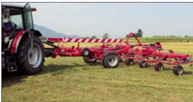
Zahvaljujoč fiksnim kolesom in dovolj široki osi je stroj enostaven za transport in upravljanje.
