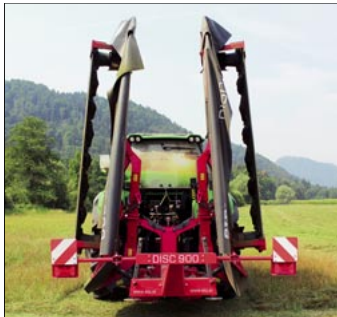
Transportni položaj kosilnice – dolžina 220 cm, širina 270 cm in transportna višina 400 cm.
