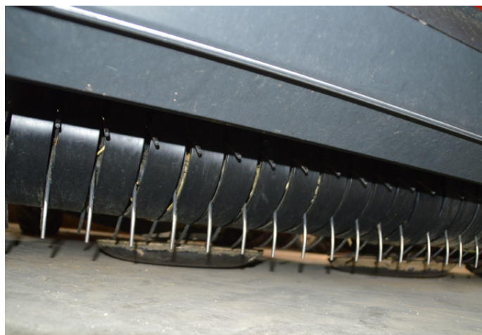
I denti del pick-up sono fissati su un supporto in plastica con fascetta di sicurezza che evita la caduta dei medesimi in caso di rottura
