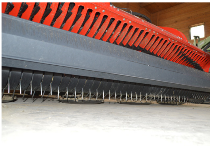
Pick-up e rotore di piccolo diametro per raccogliere senza problemi il fieno corto degli ultimi tagli
