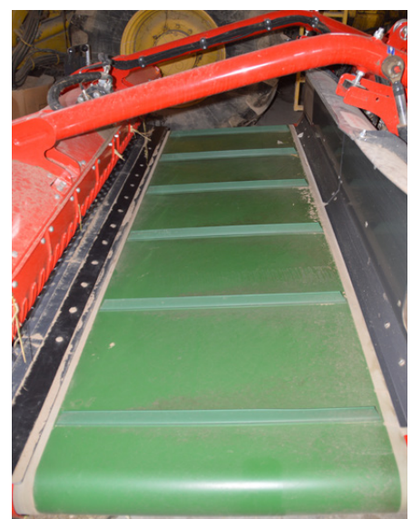
Tappeti flessibili per adattarsi facilmente a terreni con conformazione irregolare
