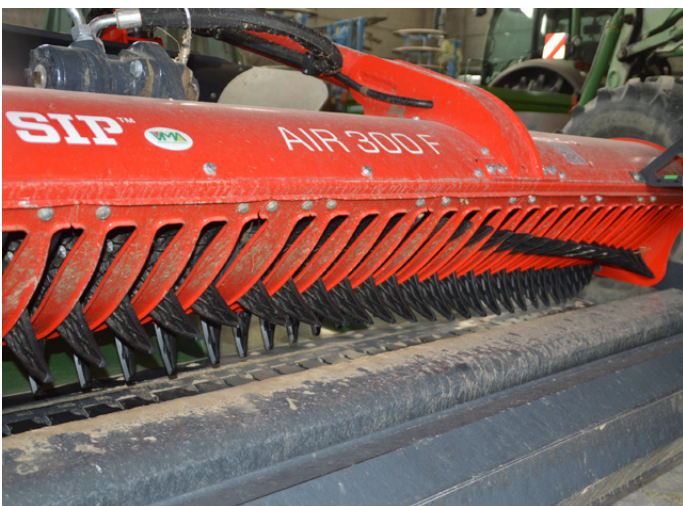
Il rotore dentato raccoglie il prodotto dal pick-up e lo deposita sui tappeti
