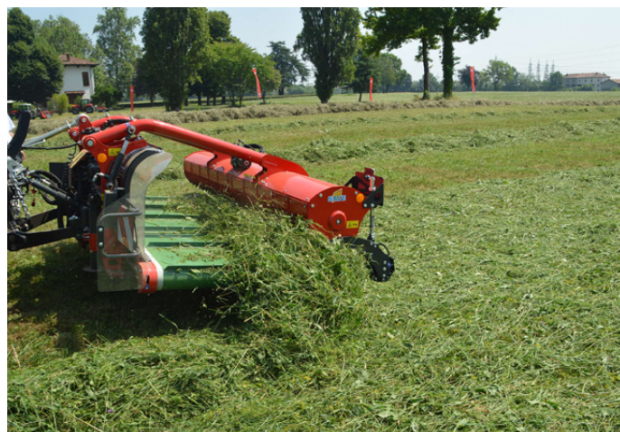
Grazie alla possibilità di scaricare il prodotto a destra o sinistra dell'attrezzo, l'Air evita il calpestamento dell'andana da parte del trattore
