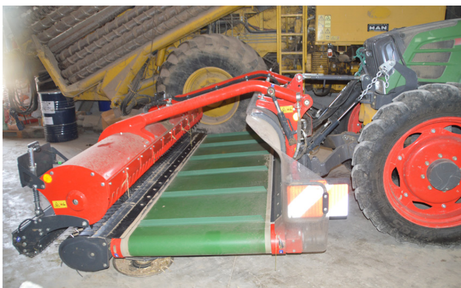
I pattini rotanti posti sotto ai piattelli facilitano lo scivolamento sul terreno senza raccogliere sporco o detriti
