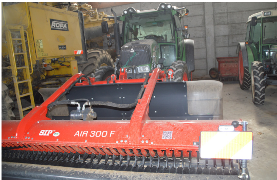
Air 300 F è un andanatore frontale con 3,6 metri di larghezza e una resa fino a 6 ettari l'ora
