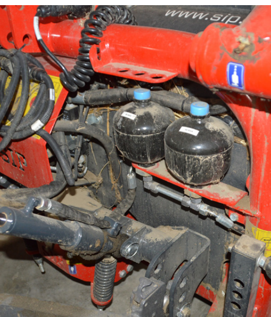
Il sistema di sospensioni idropneumatiche fa galleggiare l'Air 300 sul terreno mantenendo costante la pressione al suolo
