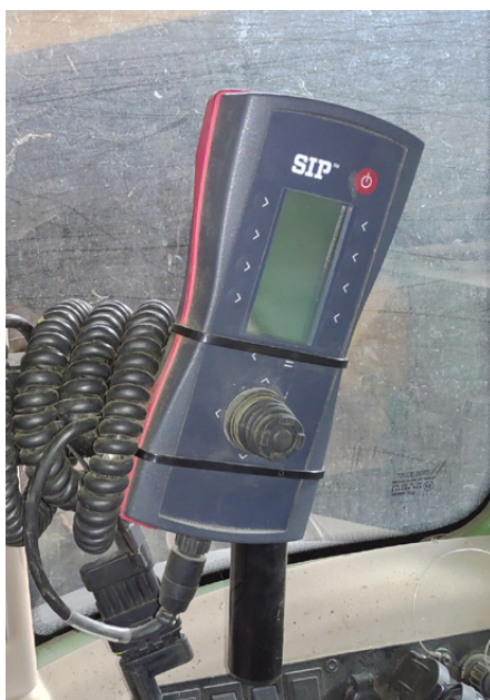
Terminale per il controllo dell'attrezzo direttamente dalla cabina
