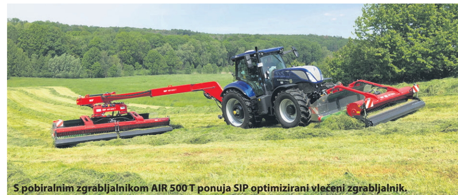
S pobiralnim zgrabljajnikom AIR 500 T ponuja SIP optimizirani vlečni zgrabljajnik.
