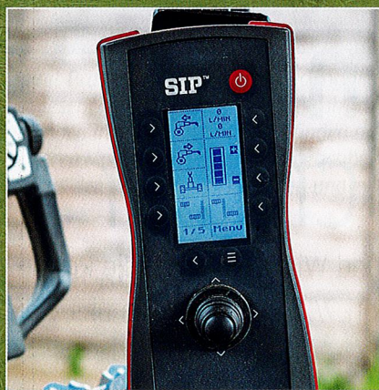
Das SIP-Terminal: Es fehlt ein Drehpoti zur präzisen Einstellung der Bandgeschwindigkeit.
