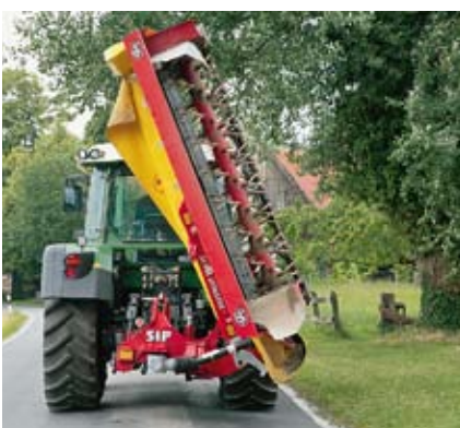
Das Mähwerk baut nah am Schlepper und klappt schon recht weit über. Schön wäre, es noch weiter klappen zu können.
