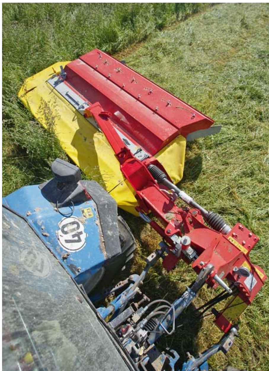
Das Mähwerk aus Slowenien hinterließ bei unserem Test einen guten Eindruck. Selbst aufwuchsreiche Bestände wurden sauber gemäht und aufbereitet. Fotos: Tovornik
