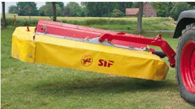
Die Aushubhöhe des Mähwerks könnte größer sein, allerdings sind wir mit gleich eingestellten Unterlenkern gefahren.
