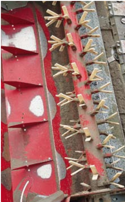
Der Aufbereiter mit Y-Fingern arbeitet mit konstanter Drehzahl. Die inneren Leitbleche sind in fünf Stufen verstellbar, die äußeren stufenlos im Langloch.
