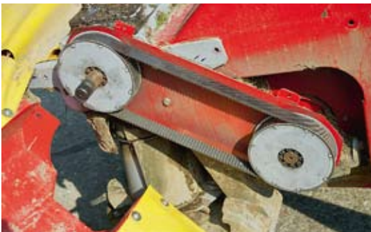
Der Antrieb des Aufbereiteters erfolgt über einen Zahnriemen ohne Spannrolle. Gespannt wird über zwei Spannvorrichtungen an der Aufbereiterwelle.
