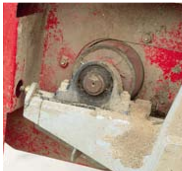
Der Antrieb des Aufbereiteters erfolgt über einen Zahnriemen ohne Spannrolle. Gespannt wird über zwei Spannvorrichtungen an der Aufbereiterwelle.
