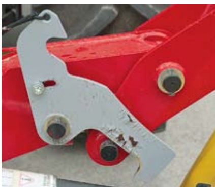
Zwei Verbesserungsvorschläge: Das Manometer zum Ablesen vom Auflagedruck ist aus der Kabine kaum ablesbar. Die Klaue zur Straßenverriegelung bzw. Aushubbegrenzung sollte verstärkt werden.
