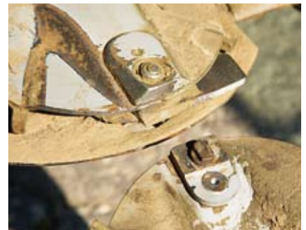
Sip setzt auf verschraubte Fixierungen der Klingen.
