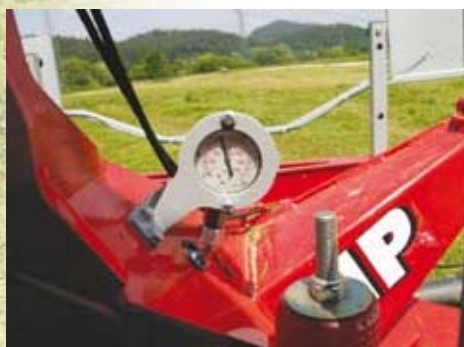
Serijska hidravlična razbremenitev zadnjih kosilnic
