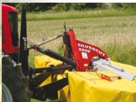
Sprednja kosilnica ima mehansko razbremenitev z vzmetmi
