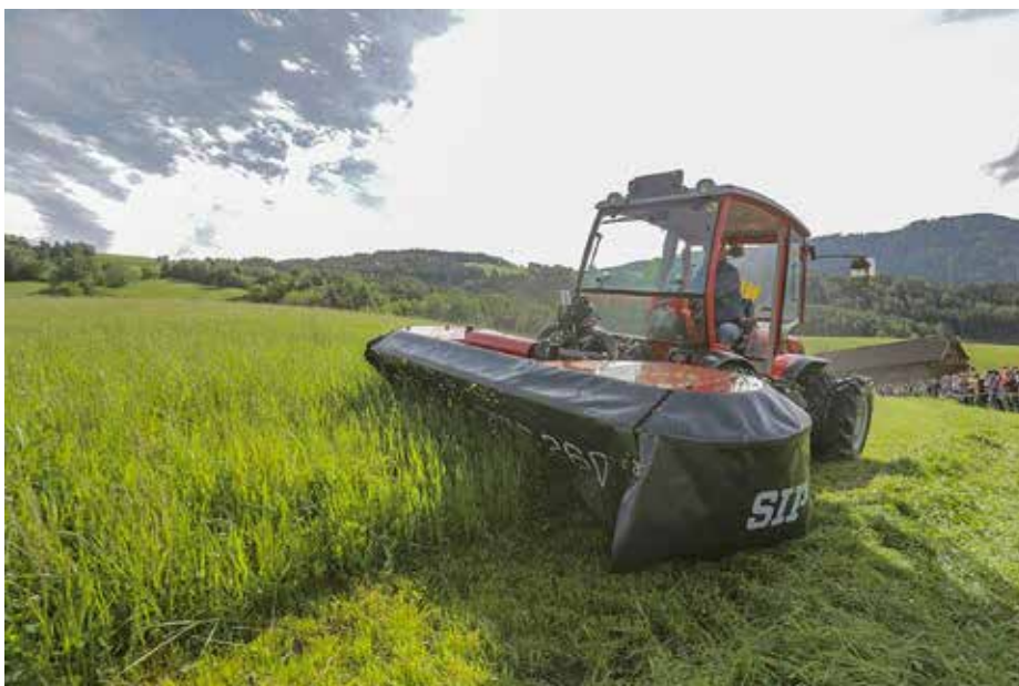
Disc F ALP so lažje sprednje diskaste kosilnice, namenjene za gorske traktorje, in so nedavni SIP-ov razvojni dosežek pri kosilnicah (foto Benjamin Žgank).
