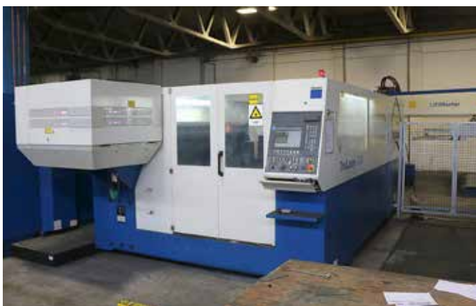
Razrez pločevine z laserskimi rezalniki je danes standard industrijske proizvodnje. V SIP-u to delo opravljajo trije različnih rezalnih moči.
