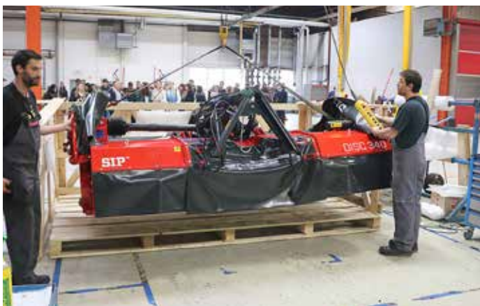
Pakiranje kosilnice po končani montaži za odpremo kupcu (trgovcu ali končnemu kupcu).
