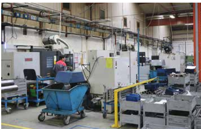
Večina mehanske obdelave materialov poteka na CNC krmiljenih strojih.
