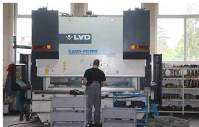
Natančno krivljenje pločevinastih delo strojev zagotavljajo trije CNC krmiljeni krivilni stroji.
