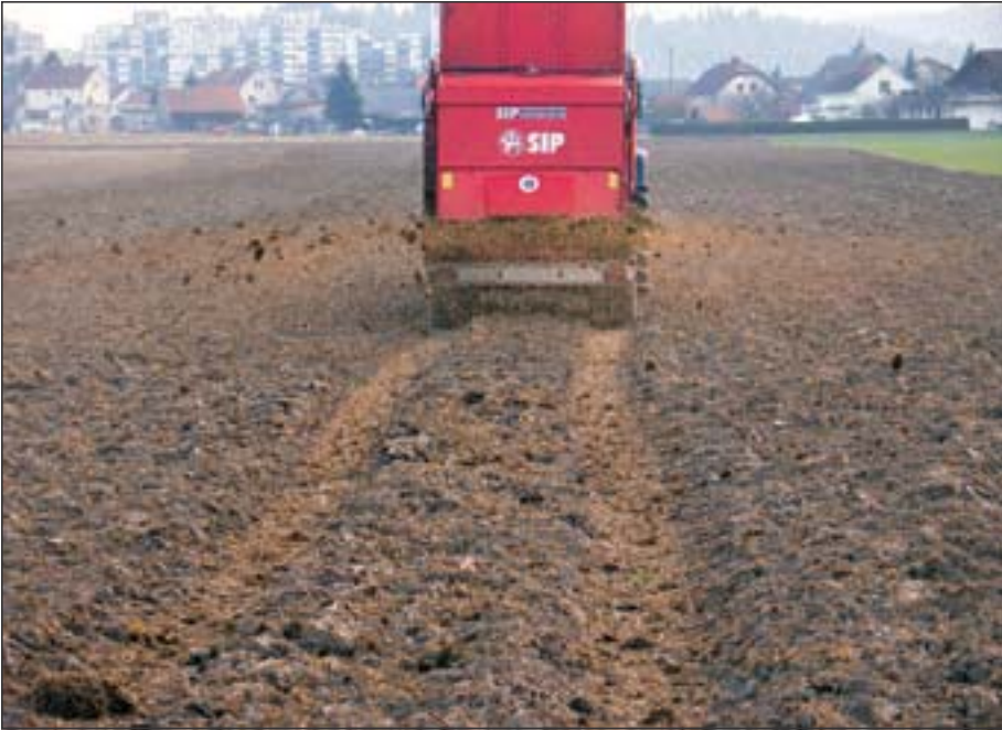
Trosenje hlevskega gnoja na njivi ob zaprtem zadnjem pokrovu omogoča raztros hlevskega gnoja tja do 24 m.
