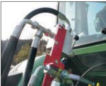
Hidravlični ventili oziroma ročice za preklp med dvema delovnim funkcijama
