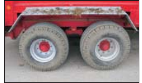
Tandemsko podvozje (kolesa) z ustreznimi pnevmatikami omogoča skupno dopustno maso 12 ton.
