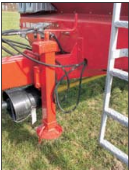
Mehanska podporna noga je dvostopenjska in omogoča hiter odklop trosilnika.
