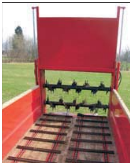
Pogled od spredaj proti zadnjemu koncu: dva verižna prenašala (veriga prenese 18 ton sile), dva horizontalna valja in dva krožnika
