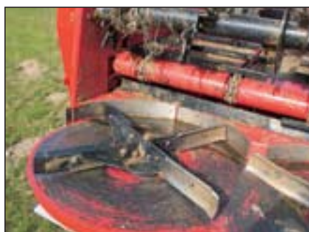
Na spodnjem zadnjem delu sta dva vrteča se krožnika z izmetalnimi lopaticami, ki omogočata raztros gnoja po širini.
