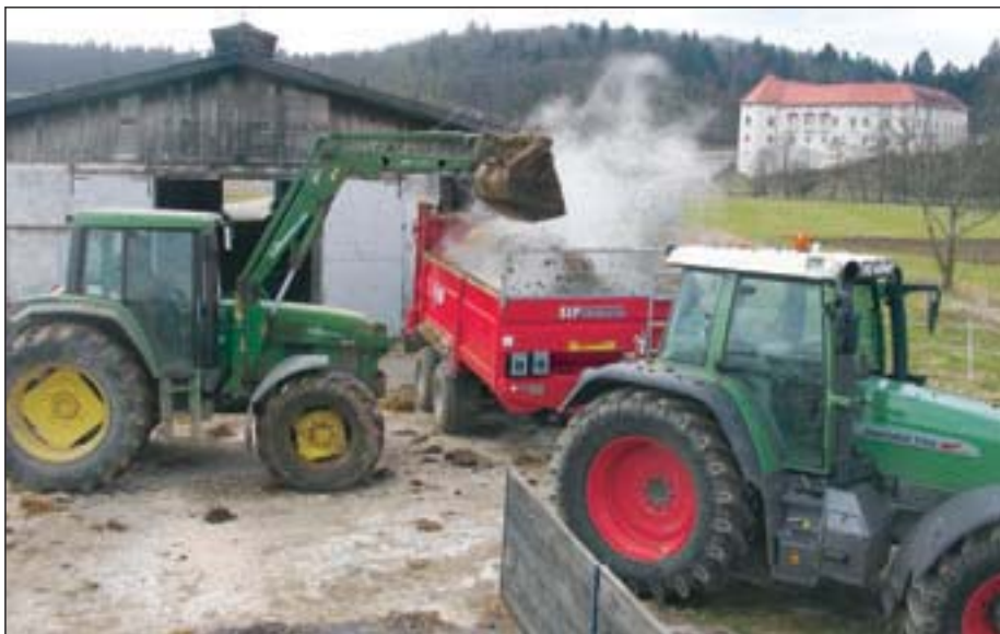
Za nakladanje hlevskega gnoja smo uporabili čelni nakladalnik. Lesena letev na bočni stranici varuje stranico pred poškodbami. Nosilnost trosilnika je 8250 kg.
