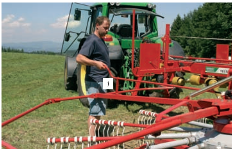
Praktična in natančna nastavitve vrtavke: 1 višina grabljenja, 2 stranski nagib
