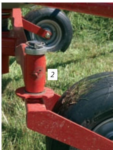
Praktična in natančna nastavitve vrtavke: 1 višina grabljenja, 2 stranski nagib
