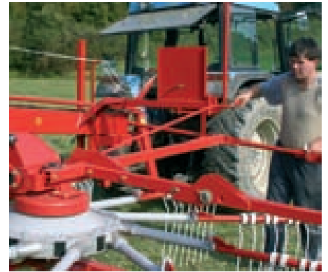
Nastavitev višine delovanja z ročico in navojnim vretenom.
