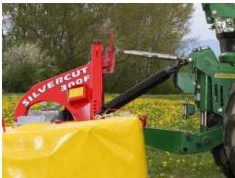
Механическая разгрузка фронтальной косилки при помощи пружин
