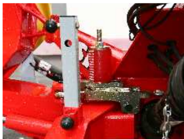
Предохранительное устройство неопреновым упругим элементом
