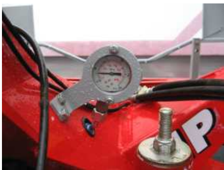
Серийная гидравлическая разгрузка задних косилок
