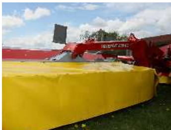
Центральное крепление режущего бруса к консольной балке
